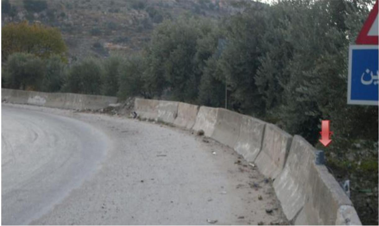
الشكل (3-9) توضع جهاز قياس السرعة بشكل مخفي
